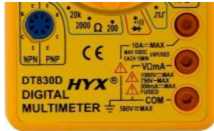
Figura 3. Entradas para conexão das pontas de provas.
