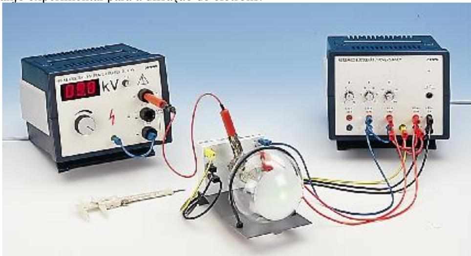
Na simulação **Difração de Elétrons**, Figura 4, estão representados: a Fonte de Alta Tensão, uma Fonte de 6,3 Vac (as saídas da Fonte Múltipla para colimação do feixe de elétrons não estão representadas na simulação, pois não são essenciais para os resultados), o tudo de Difração de Elétrons (uma visão frontal do
