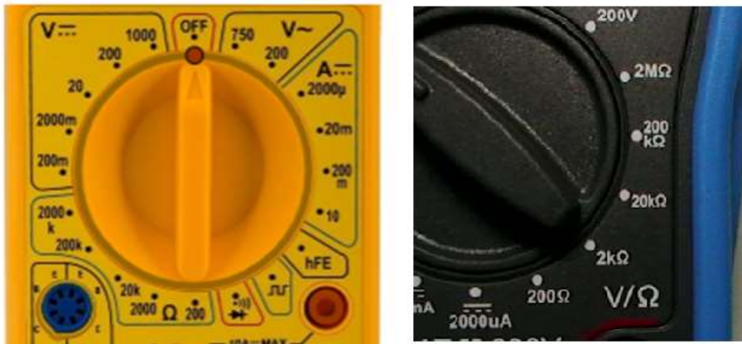
Figura 9 - Detalhe mostrando as escalas dos ohmímetros da Figura 5.
