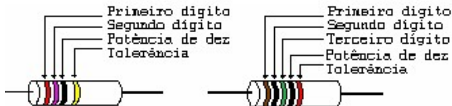
Figura 3 - Ordem de leitura e significado de cada faixa para resistores comuns (quatro faixas) e para resistores de precisão (cinco faixas).
